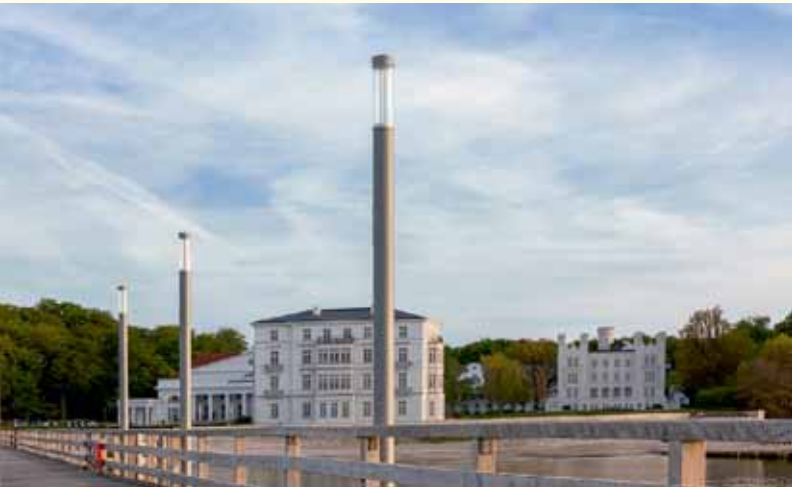
Die seitlich angefügten Lichtmasten LTM 440 LED bringen das Licht gezielt auf die Brücke. Streulicht auf der Wasseroberfläche wird vermieden. Leuchte rechts im Maßstab 1:25
