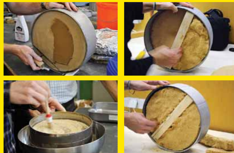
Forschen im Rahmen von [H]-House: Innenwandaufbauten aus Naturbaustoffen werden für den Emissionstest vorbereitet Fotos: Roswag Architekten
