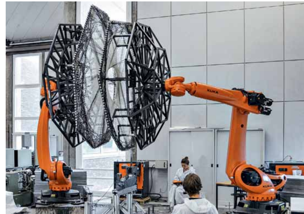
Roboter fertigen an der Universität Stuttgart die Faserbündelmodule durch kernloses Wickeln Fotos: ICD/ITKE Universität Stuttgart
