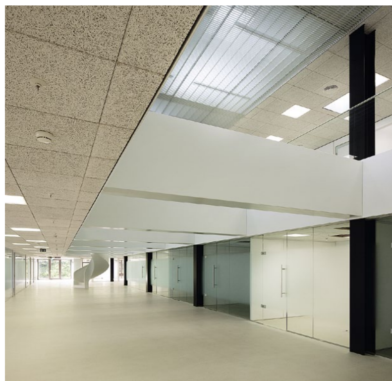
Zwischen Büros und hangseitig angeordneten Nebenräumen entstand ein zweigeschossiger Luftraum von fast 30 Meter Länge, der von frei auf der Terrasse angeordneten Oberlichtern mit Tageslicht versorgt wird
