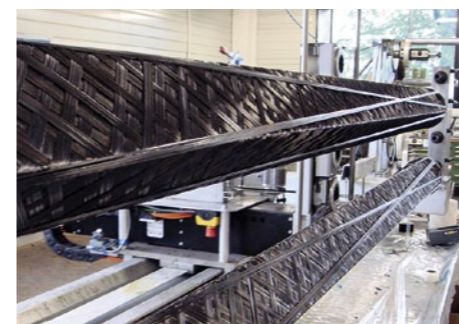
Produktion der Carbonstäbe über einer Aluminiummatrize
