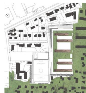
Entwurfsstrategie zur Einfügung von 58.000 Kubikmeter umbautem Raum in eine Einfamilienhausgegend: Eine „Landschaftsplatte“ mit Rasen, 180 m x 70 m groß, wird über die vorgefundene Mulde gelegt und schließt nach Osten ebenerdig an die benachbarte Wiese an. Vier eingesnchnittene Höfe belichten die
