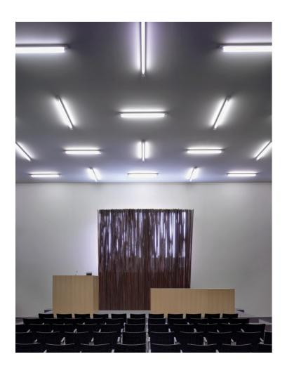
Der Kirchenraum selbst ist für 250 Personen bemessen. Das Innere ist schlicht, ja kahl. Der Saal ist eine 17 Meter lange, 11 Meter breite und 7 Meter hohe weiße Box mit nur einem Fenster und einem Raster von Leuchtstoffröhren zur Beleuchtung. Die wichtigsten Einrichtungsgegenstände, Kanzel, Altar und Orgel, sind Blöcke aus Eichenholz ohne Verzierungen. Die niederländische reformierte Kirche hält nichts von Schmuck. Ihr Inneres und ihr Glauben sind geradlinig und streng wie das Muster der Polder.
