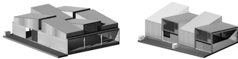
Die Cité Artisanale bündelt 4500 Quadratmeter Gewerbefläche, aufgeteilt in Module von 7 mal 14 Metern. Alle Gebäude integrieren die umlaufende Betonmauer.
