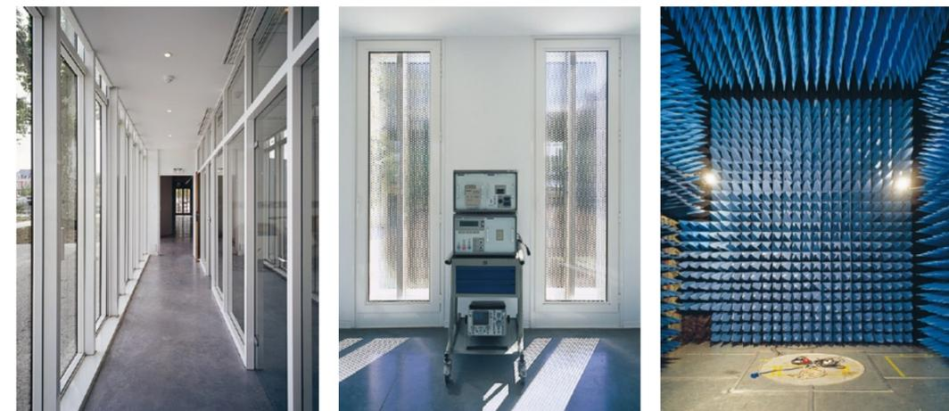
Das zweigeschossige Versuchslabor im Kopf des Neubaus ist mit Wänden zur Ausschaltung elektromagnetischer Wellen ausgestattet. Die doppelschalige Fassade mit perforierten
