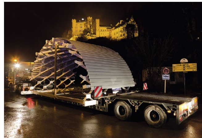
Schwerlasttransporter mit Dachsegment. Im Hintergrund Schloss Hohenschwangau.
