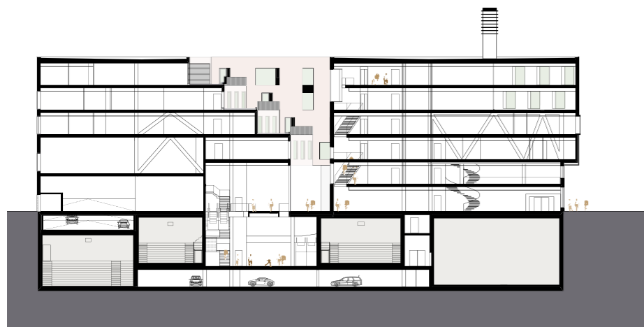
Längsschnitt mit den sich abtreppenden Terrassen in den Bürogeschossen, mit den Kinosälen und der Tiefgarage in den Untergeschossen
