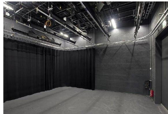
Für optimale Aufnahmebedingungen stehen die Studios als „Haus-in-Haus“-Konstruktion frei im massiven Sockel der Hochschule.
