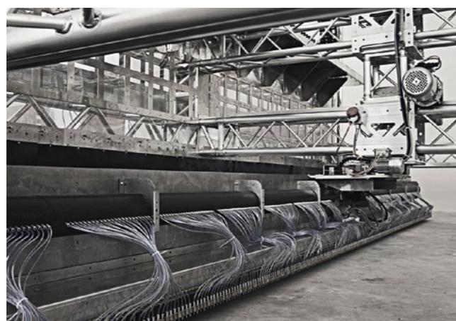
In Reihe angeordnete Düsen des Druckkopfs des Großformatdruckers zur Verteilung des Bindemittels auf dem Granulat.
