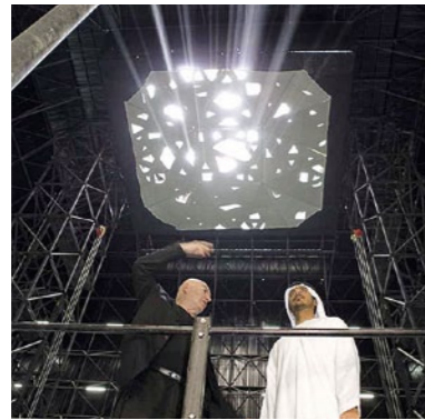
Jean Nouvel und Scheich Sultan bin Tahnoon Al Nahyan am Modell. Um die Dachhaube des Museums zu optimieren, wurde ein Simulator der Lichtführung im Maßstab 1:1 gebaut. Vorstudien fanden 2009 mit Transsolar an der HFT Stuttgart statt.
