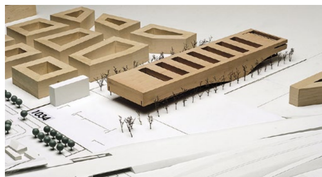
1. Preis | Kohlmaier Oberst Architekten, Stuttgart, schaffen durch die Öffnung des Erdgeschosses des langgezogenen und an beiden Stirnseiten weit auskragenden Sichtbetongebäudes eine offene Passage vom Tempelhofer Damm zum ehemaligen Flugfeld. Rechts: Rasterkonzept mit Kreuzstützen und schematischer Darstellung der flexiblen Nutzungsbereiche im 1. Obergeschoss. Das 2. Obergeschoss ist komplett stützenfrei. 1. Obergeschoss im Maßstab 1:1000
