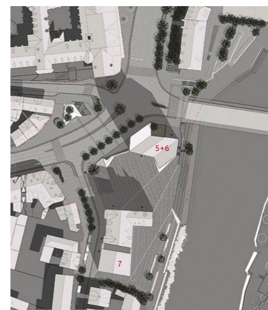
2. Preis | Olympia Chatzopoulou und Dimitra Figa setzen einen 7-geschossigen Turm für die Bibliothek an den Brückenkopf und pflastern einen großen Platz mit Sitzstufen zum Ufer. Das Gebäude der Volksbank erweitern sie ein Beratungszentrum für Senioren. Maßstab 1:2000
