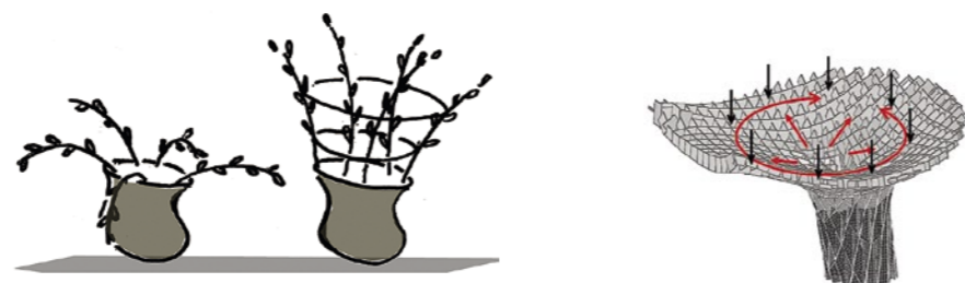
9 Analogie zur Tragwirkung eines mit Zugstangen versteiften Parasols
