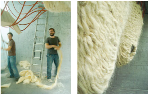
Auf dem langen Weg zur Verwirklichung eines gewebten Holzhauses: In Berlin haben Donat Aurel Grissemann und Simon Oberhammer mit einem Kettfaden aus Gartenschläuchen und einem Schussfaden aus Hanf experimentiert. Fotos: Isolde Nagel
