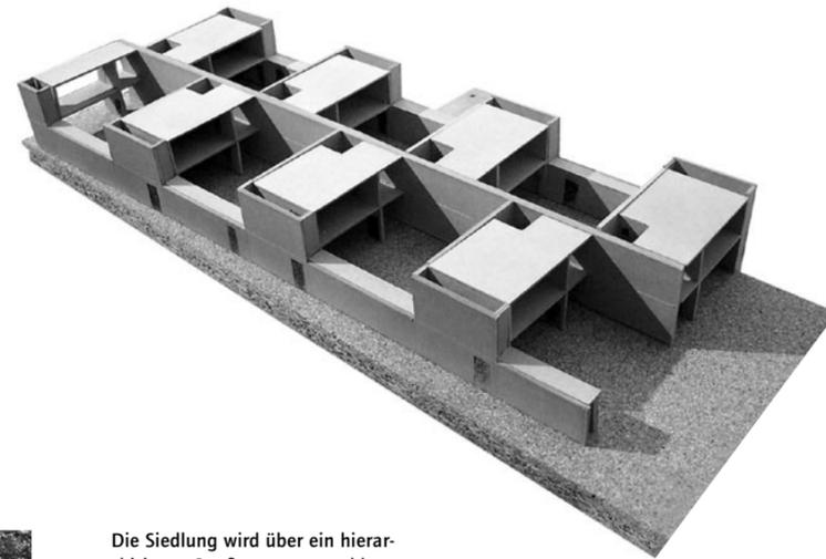
Die Siedlung wird über ein hierarchisiertes Straßensystem erschlossen. Die konventionelle Zonierung von Fahrbahn und Straßenrand ist aufgehoben und wird als erweiterter Lebensraum interpretiert, punktuell ergänzt durch Plätze unterschiedlicher Nutzungen. Nach einem Städtebauentwurf wurden in der Vertiefungsphase für die durchschnittlich 110 Quadratmeter großen Häuser sieben Grundrissvarianten entwickelt.
