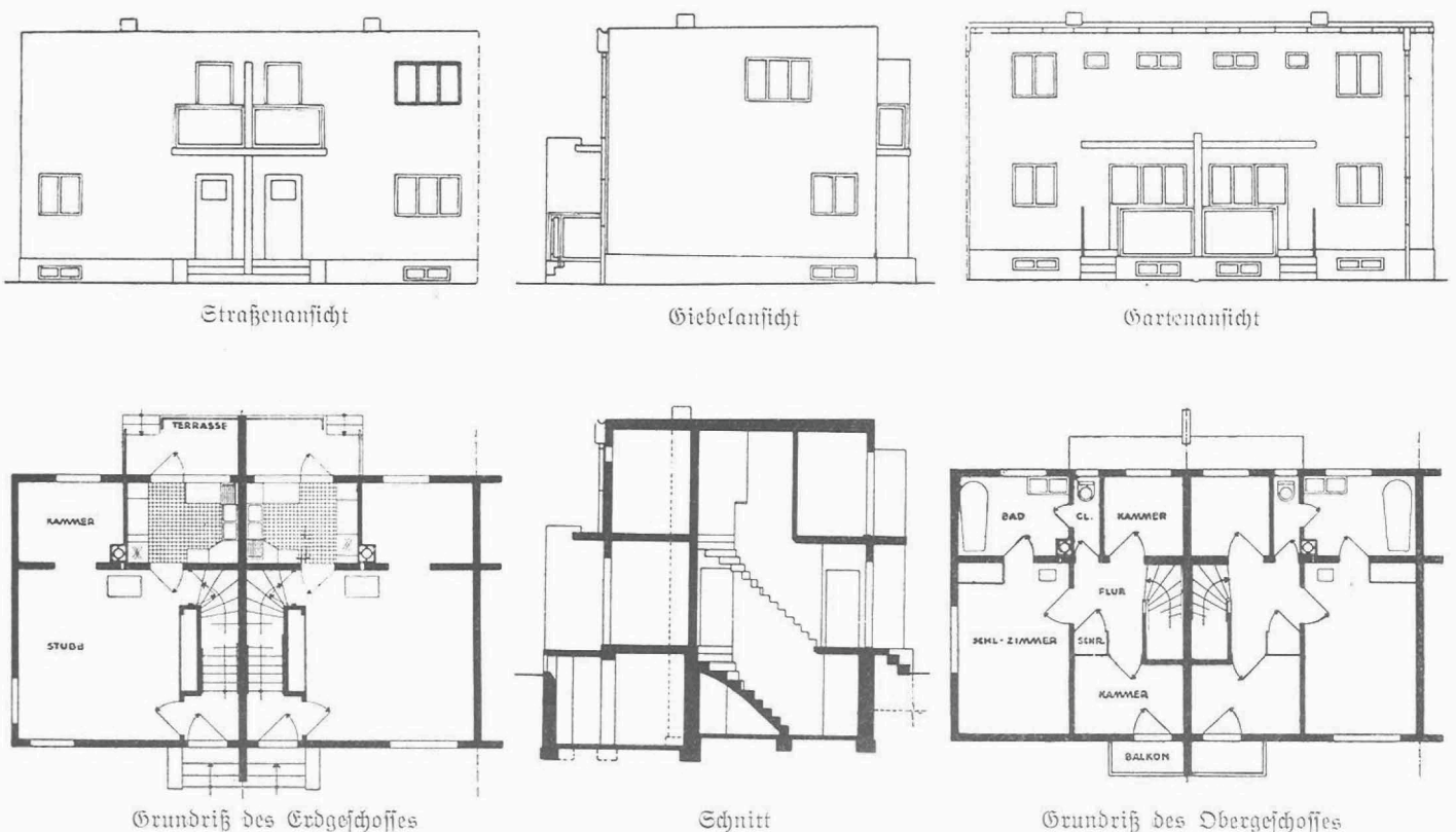
Abb. 16. Zweifamilien-Haustyp der Montagebauten in Frankfurt-Praunheim. M. 1 : 200
