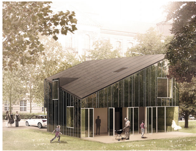
2. Preis | Das Team der TU Dresden entwickelt das Volumen entsprechend der maximalen nach Süden orientierten Fläche. Die PV-Module werden als schwarze, rahmenlose Fassadenelemente architektonisch integriert. Dachform und Wandverkleidung können sich je nach Lage ändern.
