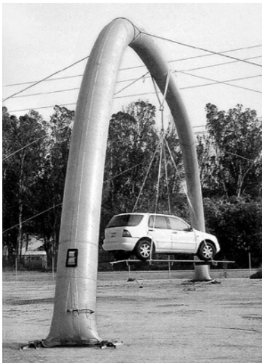
Unten: Das AirBeam ist ein aufblasbares Trägerelement aus geflochtenen Textilfasern von Vectran® mit einer Ummantelung aus Polyurethan. Es wurde für die US-Armee entwickelt und wird von Vertigo Inc. produziert. Rechts: Das aus maschinengesticktem Polyester bestehende Schulter-Implantat haben Ellis Developments Ltd. entwickelt. Der Hersteller ist Pearsalls Ltd., England. Foto: Matt Flynn
