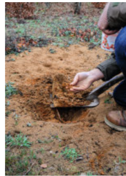
Lehm wurde vor Ort regenerativ als Baumaterial gewonnen.
