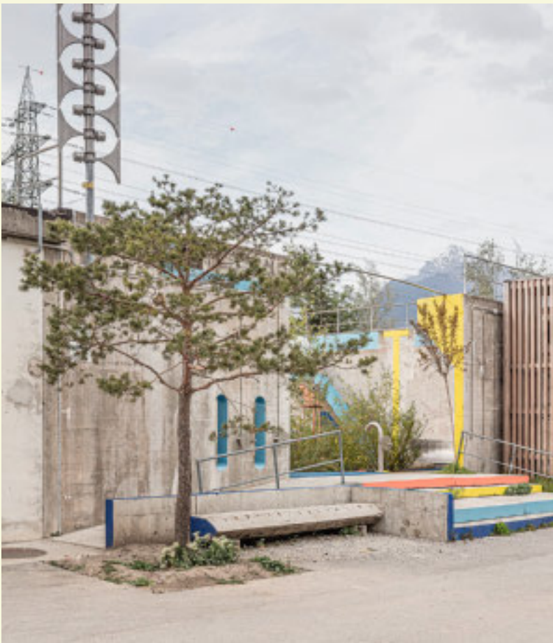
Die Betonzylinder, die für die Wasserbecken ausge- schnitten wurden, kom- men als mit blauem Tartan beschichtete Sitz- und Spielelemente wieder zum Einsatz. Schnitt im Maßstab 1:250
