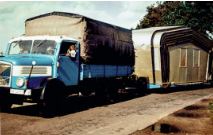
Transport einer kompletten REH Halle. Der Bodenrahmen der zusammengesetzten REH Halle wird durch eine zweiteili-
