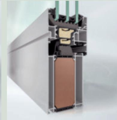
Schüco AWS 75.SI+ optimized mit 75 mm Bautiefe ab 178 mm Ansichtsbreite: Passivhaus zertifizierte Wärmedämmung mit  $U_i = 0,79 \text{ W}/(\text{m}^2\text{K})$
