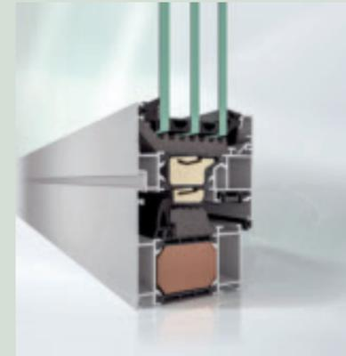
Schüco AWS 75.SI+ optimized in 75 mm Bautiefe bei 117 mm Ansichtsbreite: Wärmedämmung auf Passivhaus-Niveau mit  $U_i = 0,94 \text{ W}/(\text{m}^2\text{K})$
