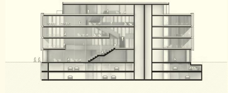
Im 5. OG befinden sich ein Fitnessraum, die Haustechnik und der Zugang zur begrünten Dachterrasse. Grundrisse und Schnitt im Maßstab 1:750
