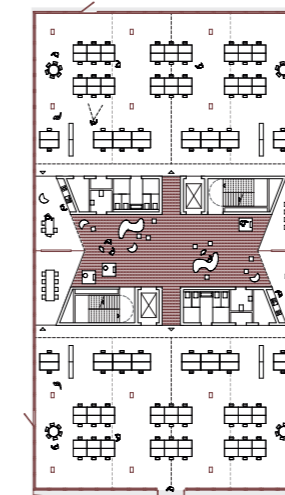
2. Preis AFF Architekten arbeiten mit gestalterischen Zitatens aus dem Industriebau. Das Erdgeschoss ist freigespielt, die Obergeschosse sind als rückbaubare Holz-Stahl-Hybridkonstruktion ange-dacht. Grundrisse EG, 1. und 2. OG im Maßstab 1:750
