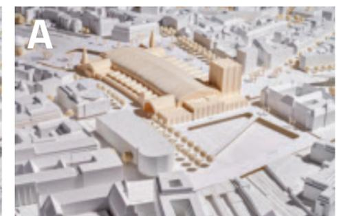
**1. Preis** bof mit huterreimann kopieren das Volumen des Bahnhofs für den quer gesetzten Neubau. Unter dem Glasdach gibt es neue Eingänge zum Südsteig. Im Neubau befinden sich Büros und Direktzugänge zu den Gleisen.
