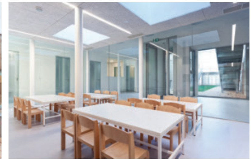
Das Innere wird von zurückhaltenden Farben geprägt: Linoleum auf Boden und Wänden, Akustikplatten an Decke und Wand.
