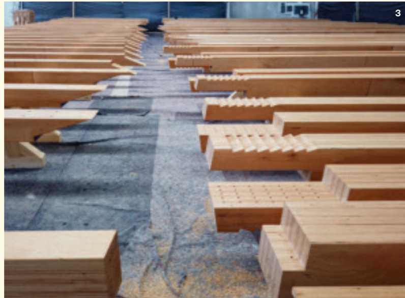
Schrauben ermöglichen die maximale Tragfähigkeit der Knoten 1 , Holzverbindung 2 . Holzverschnitte der Nebenträger 3 .
