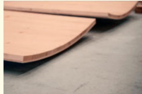
Die kontrollierte Krümmung gelingt durch die Kombination einer bereits getrockneten („passiven“) Holzschicht mit einer noch feuchten („aktiven“) Schicht vor dem endgültigen Trocknen.
