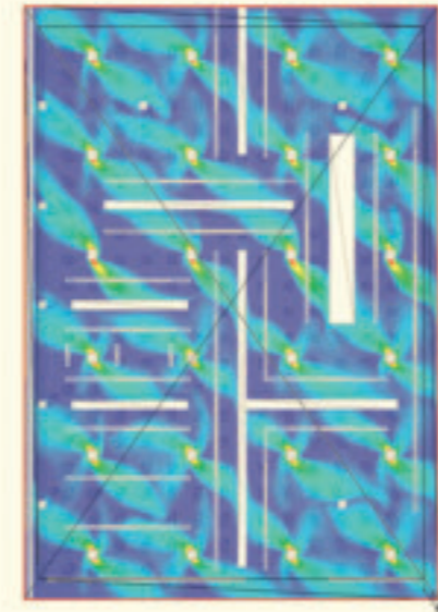
Strömungsbild der Drallauslässe im Ausstellungsbereich Bild unten: Die Kondensatbildung an der Bestandsverglasung
