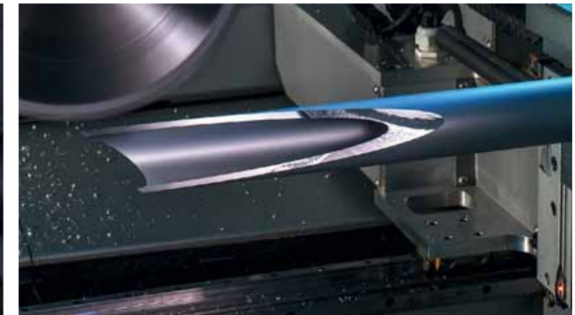
V.l.n.r.: Die Elemente des Profils werden im Werk automatisch zugeschnitten. Anschließend werden sie in der Werkstatt vormontiert. Schließlich erfolgt die Montage der parametrischen Fassade am Objekt bzw. als Prototyp. Fotos: Schüco, Lukas Palik
