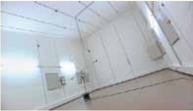
Kernstück des Akustiklabors im Center für Klimatechnik und Akustik von Trox (links) sind die vom Baukörper entkoppelten Hallräume, in denen alle akustischen Messungen durchgeführt werden. Fotos: Trox
