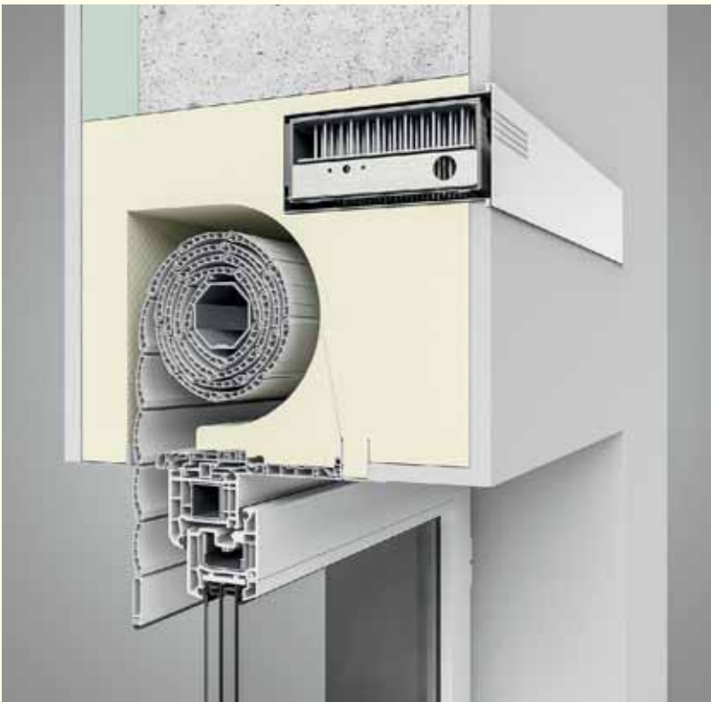
Das Schüco VentoTherm-System kann in Thermo NB-Aufsatzkästen (30 cm Höhe) mit Rollläden in den Ausführungen Revision innen oder außen sowie mit Raffstore-Behängen verbaut werden.
