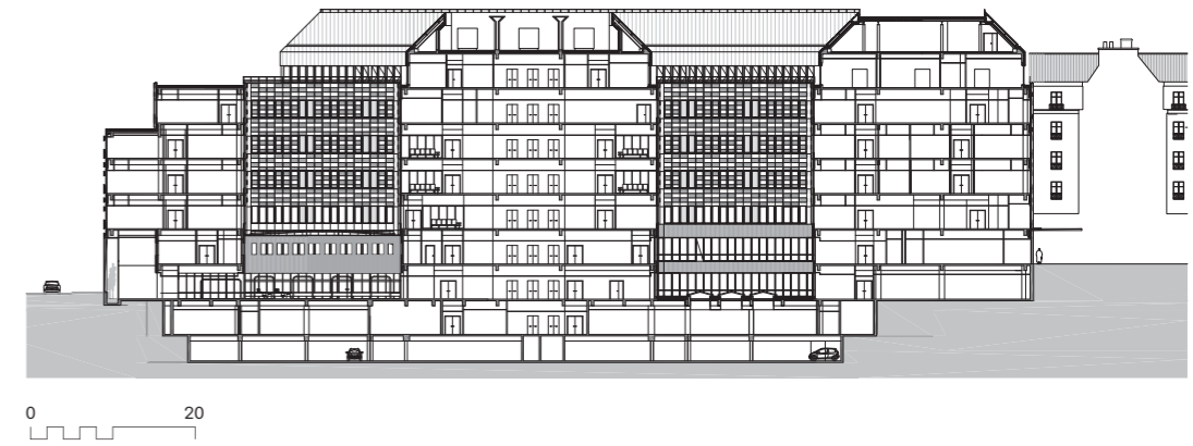
Der Gebäudekomplex mit den unterschiedlichen Fassaden an der Rue de Sèvres. Schnitt durch den Laennec-Bau mit zwei Höfen, der Passage entlang der Straße und den sich abtreppenden Obergeschossen Schnitt im Maßstab 1:1000
