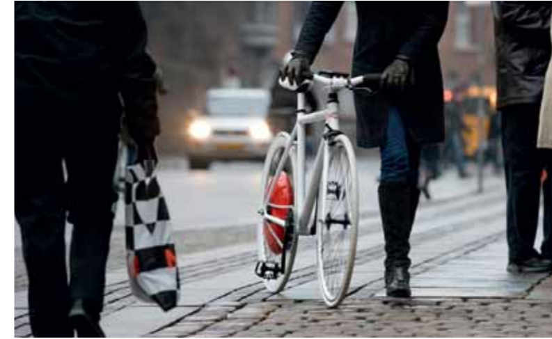
Nachrüstbarer Elektromotor für Fahrräder Foto: Max Tomasinellic, The Copenhagen Wheel, MIT SENSEable City Lab
