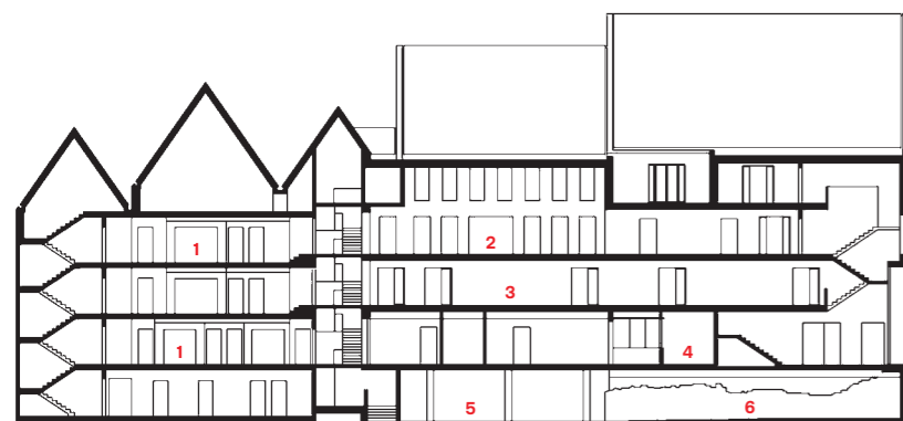
Drei Schichten: Glasfassa- de, acht Jahrhunderte altes Mauerwerk, V-Stützen aus Beton Schnitte im Maßstab 1:500
