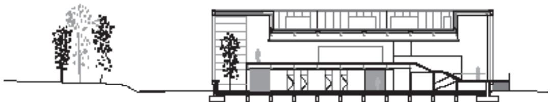
Im Eingangsbereich lässt die transluzente Fassade auch Licht ins Gebäude; ansonsten ist sie meist durch eine zweite Wand verdeckt
