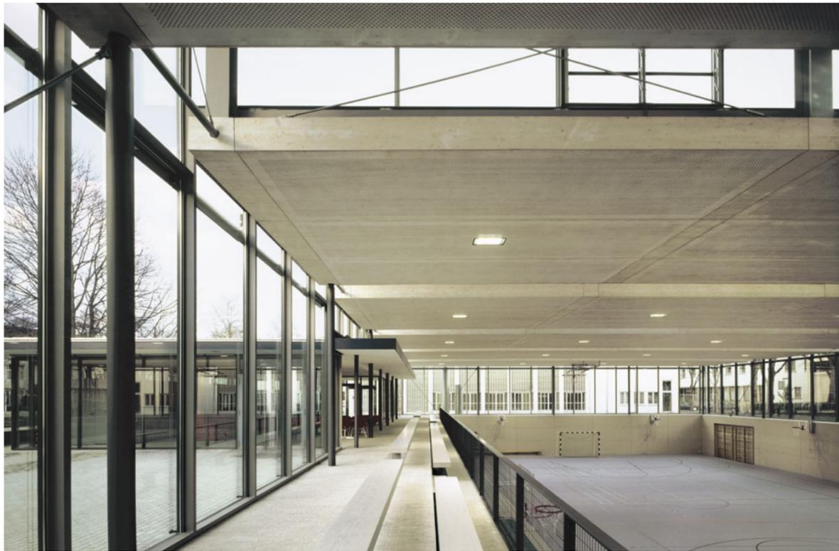
Die Tragkonstruktion aus Holzleimbändern und geknickten Stahlpfetten bildet eine rechtwinklig gefaltete Struktur. Die Sheds sind als kubische Belichtungskörper ausgebildet und öffnen sich nach Norden. Die Deckenfläche besteht aus Holzrippenelementen, die eine glatte Untersicht bilden. Oben: Blick über die schmale Zuschauertribüne in die Halle. Links der Eingangspavillon
