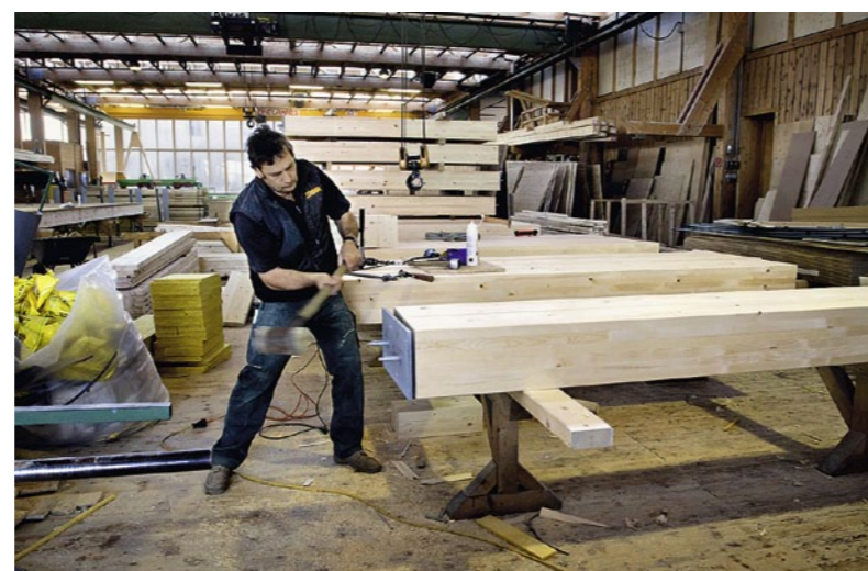
Fertigung der Fassadenelemente in der Werkstatt. Es gibt nur einen Stützenquerschnitt, je nach Belastung werden zwei oder auch drei Stützen verbunden.
