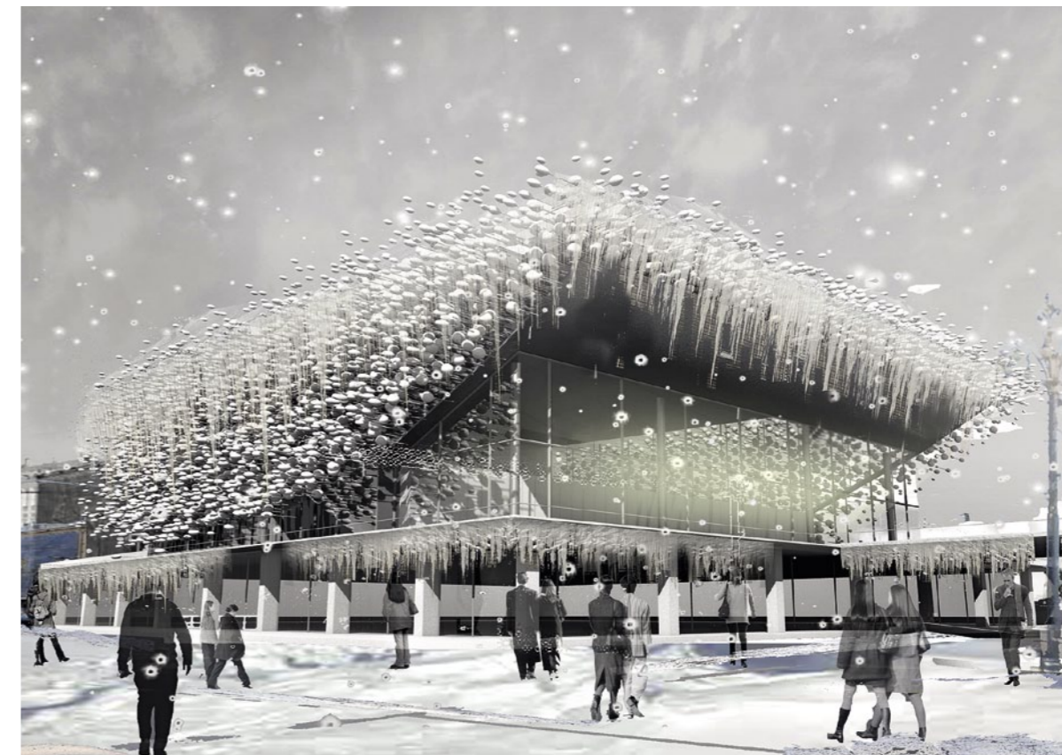
1. Preis | Mit „Frozen in time“ geht Juan Andrés Díaz Parra weit über eine Definition von Hülle hinaus. Er will das Kino mit einer mehrschichtigen Konstruktion umstellen – bestehend aus einer wasserdampfführenden Schicht und kleinen Corian-Kugeln, durch die Dampf versprüht wird. Im Sommer soll er kühlen, im Winter zu Eis gefrieren. Parra erklärt, er habe sich von Puschkins Gedicht „Wintermorgen“ inspirieren lassen, das veranschaulicht, wie der russische Winter die Landschaft belebt und neu gestaltet.
