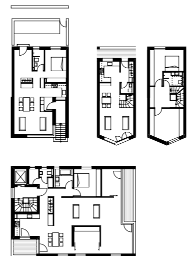
Übersichtsplan: Auslobung; im Maßstab 1:10.000, Eingangsebene 1:1000, Wohnungstypen (5–6-Zimmer-WG 130 m 2 , 3-Zimmer-WG 75 m 2 , Maisonette 90 m 2 ) 1:500
