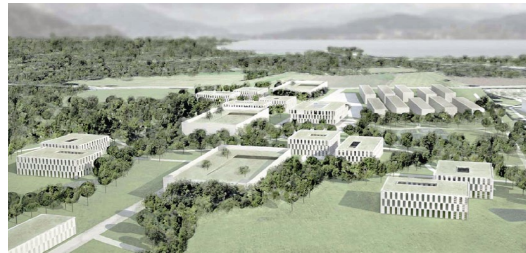
▲ 2. Preis | Marte.Marte Architekten schlagen einen sechs-geschossigen Würfel mit Treff- und Freizeiträumen als Mittelpunkt des neuen und alten Lakeside Parks vor. Im Obergeschoss dreier Kuben mit Innenhof sollen die Pkws verstaut werden; im Erdgeschoss liegen auf Sichtebene die Büros der Firmen und Institute. Lageplan im Maßstab 1:10.000
