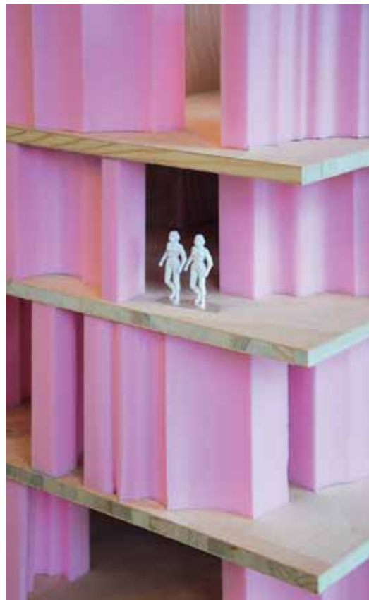
Links: Das Modell des Smart Material House' für die IBA Hamburg zeigt die Gestaltungsvarianz: Da die Wandelemente nicht übereinander zu stehen brauchen, lässt sich jedes Geschoss individuell gestalten. Entwurf mit regelmäßigen Geschossen für ein 12-geschossiges Wohnhochhaus in Berlin-Friedrichshain. Abbildungen: Barkow Leibinger
